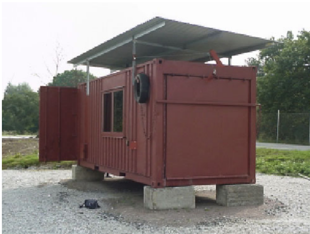
Obr. 2 – Backdraftový kontejner - tlakový panel v uzavřené poloze [L7]
