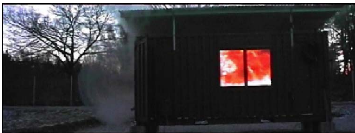
Neshořelé plyny jsou teplotní expanzí vytlačovány z kontejneru
