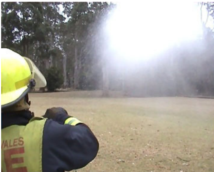
Obr.19 – Vytváření pulsu vodní mlhy
