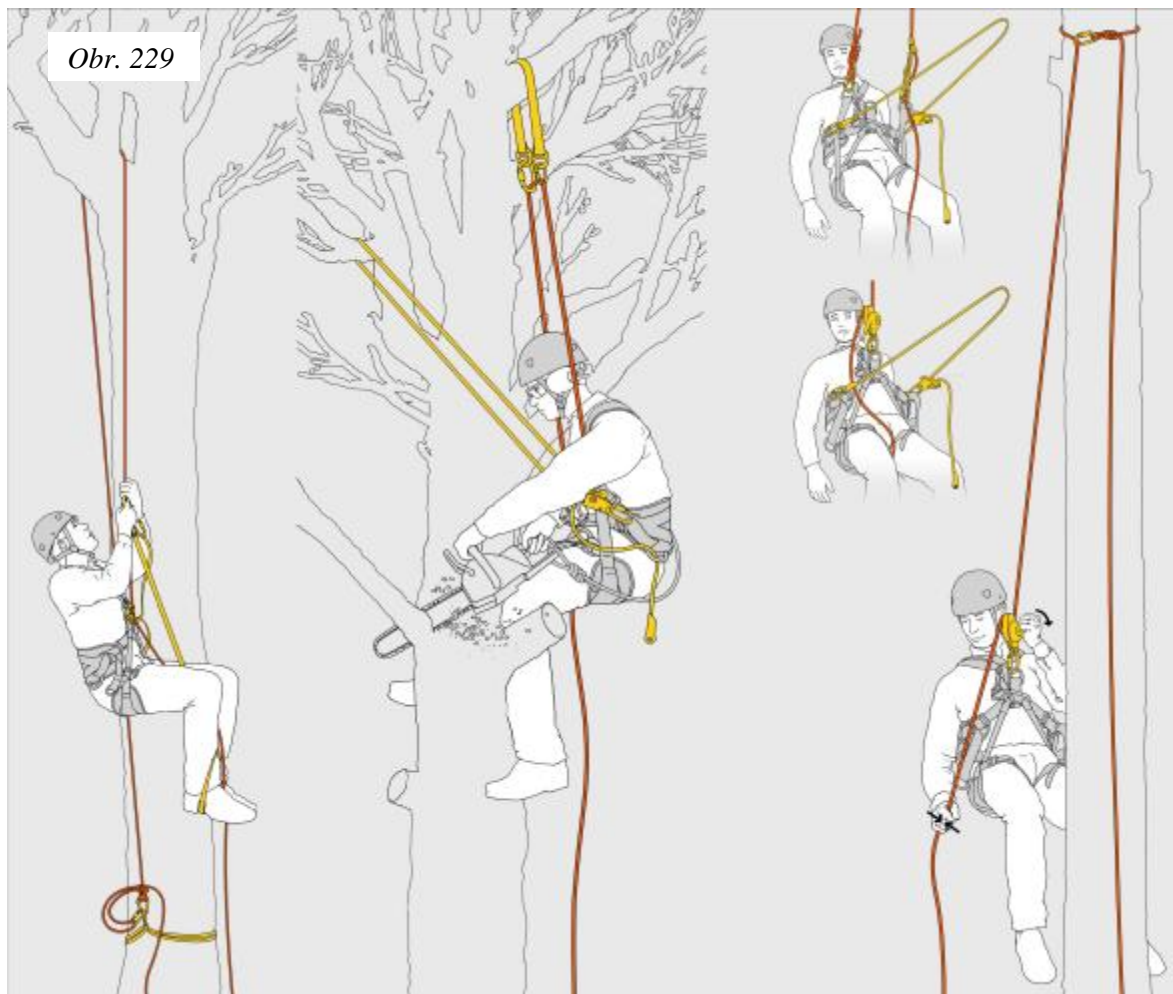
Na obr. 229 jsou schematika znázorněny výstup, sestup, jištění a práce na stromě.
